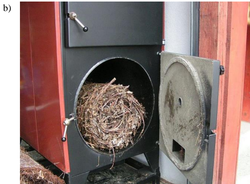
Rysunek 6. Wykorzystanie biomasy sadowniczej: a) zbelowane gałęzie z przycinki ,b) kocioł malej mocy do spalania beli [10] (fot. A. Dyjakon)
